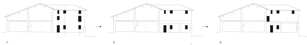
schema di trasformazione del fronte interno nord-est
